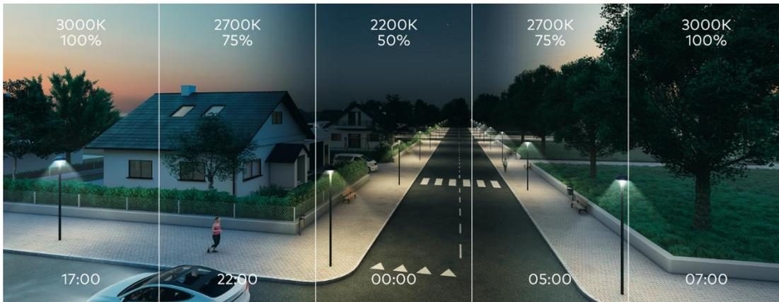
Carat può avvalersi anche di NightTune, una tecnologia che opera miscelando la luce da LED caldi e neutri al fine di ottenere temperature di colore e livelli di brillantezza differenti.
